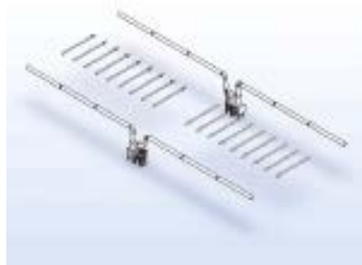
System podwójny z dwoma filtrami i dwoma wentylatorami.
